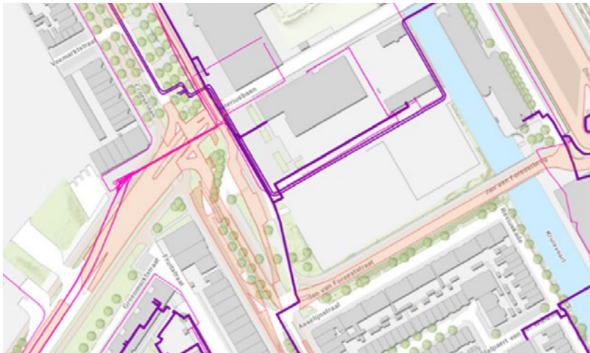
Afbeelding (b): Overzicht warmtenet en midden spanningsleiding.
