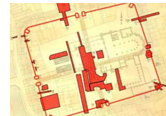
afb. 13: beperkingen in ondergrond zijn groot (kabels, leidingen, archeologie), rode vlakken zijn meest kansrijk voor het planten van nieuwe bomen
