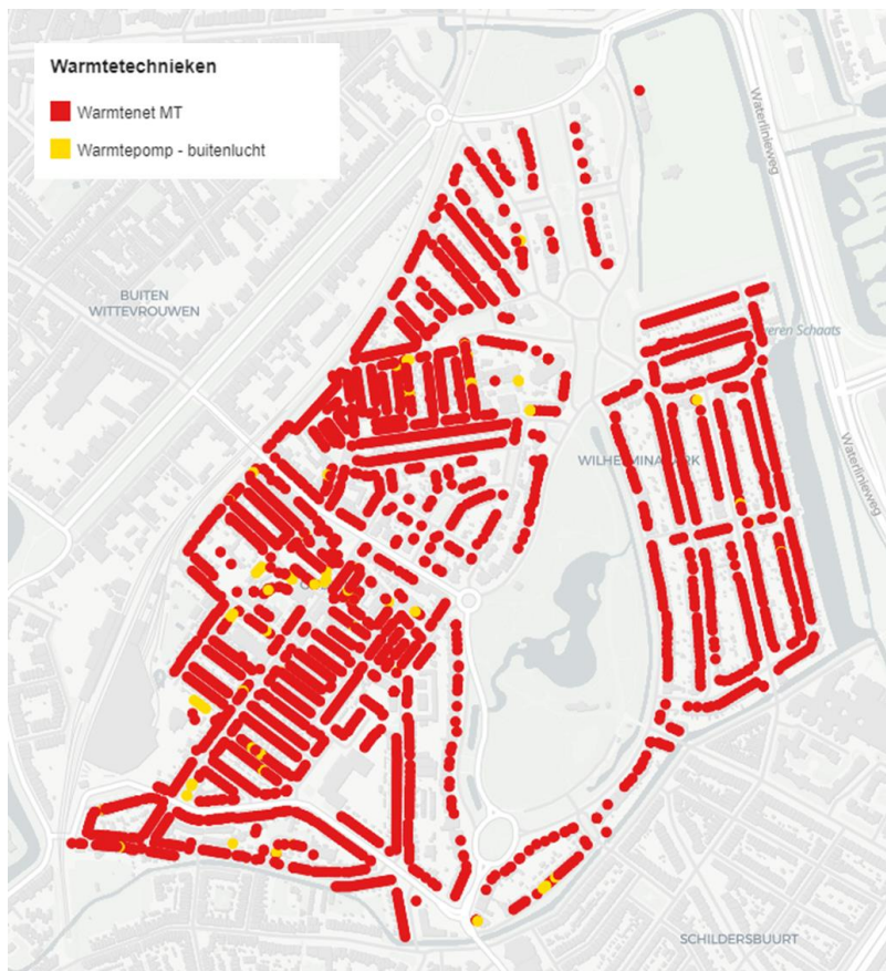
Figuur 4 - Warmtetechniek met de laagste kosten voor de eindgebruiker in het basisscenario 1 (Screenshot CEGOIA)
